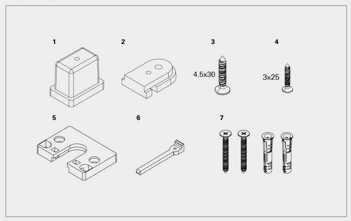
Accoppiare i pezzi 1 e 2 (1.1) utilizzando la vite 3 nel foro centrale (A); Eventualmente bloccare la rotazione mediante l'inserimento della vite 4 in uno dei due fori laterali e foro piccolo (B).
